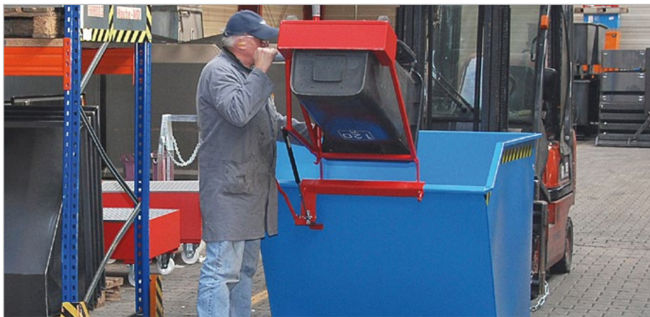
Système de basculement interne
