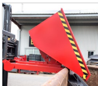
Basculez par le point de basculement n°1
