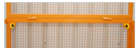
Points d'ancrage pour PSA (EPI)
