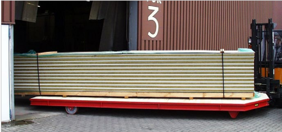
Transport de charges longues, rayon de braquage minimal grâce à la prise directe
